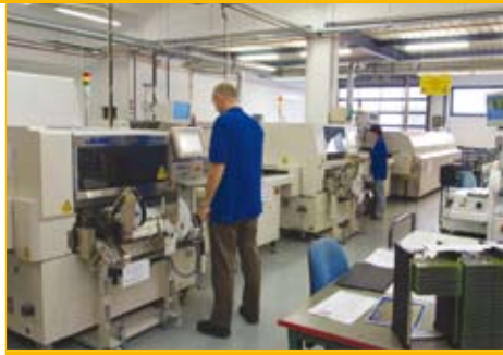
SMD-Bestückungslinie mit Juki-2020- und 2060-Bestückern und Rehm VS7 Reflow-Konvektions-Lötstation
