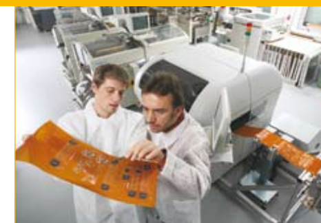
Linie zur Produktion von Folienschaltungen im Rolle-zu-Rolle-Verfahren am Lehrstuhl FAPS
